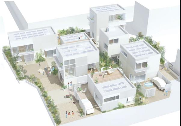
ろじひろば万代町の全体パース図。プライバシーを保つため、他の住戸の開口部と向き合わない配置になっている。
