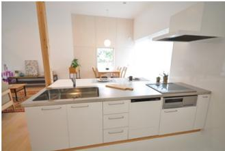
キッチンの床はリビング・ダイニングより一段下げ、料理をする人と座っている人の視線が同じ高さになるようにしている。
